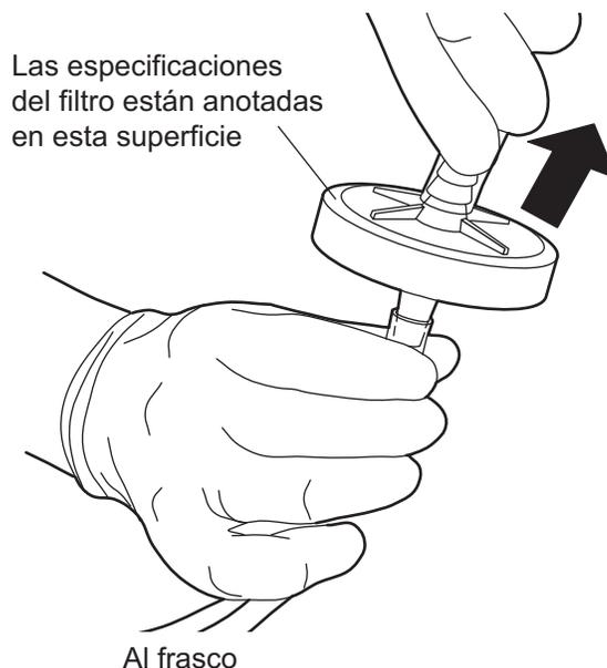
5. Extraiga el filtro para residuos de la parte inferior del tubo. Puede que tenga que cortar el tubo.
