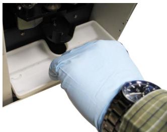
Figura 7-13 Coloque o tabuleiro de recolha no compartimento. Encaixe os parafusos nas reentrâncias do tabuleiro.
