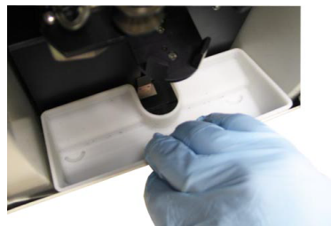
Figura 7-13 Coloque o tabuleiro de recolha no compartimento. Encaixe os parafusos nas reentrâncias do tabuleiro.
