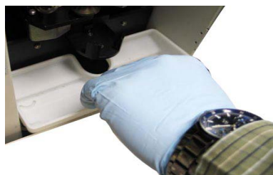
Figura 7-13 Collocare la vaschetta di raccolta nell'armadietto. Inserire le viti nelle tacche sulla vaschetta.
