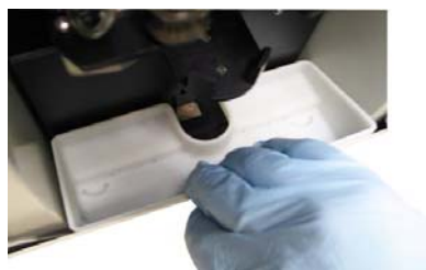
Figura 7-13 Collocare la vaschetta di raccolta nell'armadietto. Inserire le viti nelle tacche sulla vaschetta.
