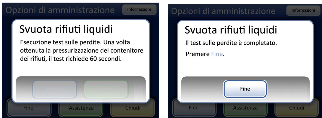
Figura 8-11 Test sulle perdite del sistema di scarico
