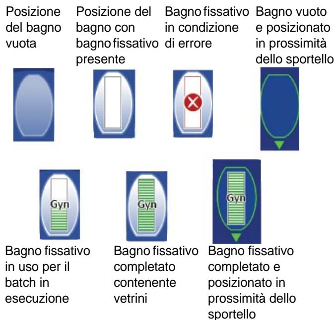
Figura 6-14 Stato dei bagni fissativi - Esempio riferito a vetrini contenenti campioni ginecologici
