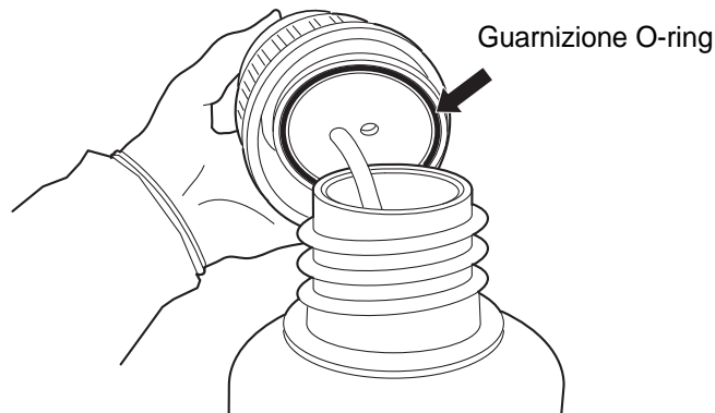
Figura 8-10 Ispezione della guarnizione O-ring del contenitore dei rifiuti
