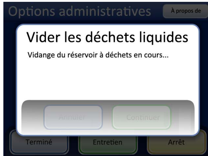
Figure 8-7 Dépressurisation du bidon d'évacuation des déchets
