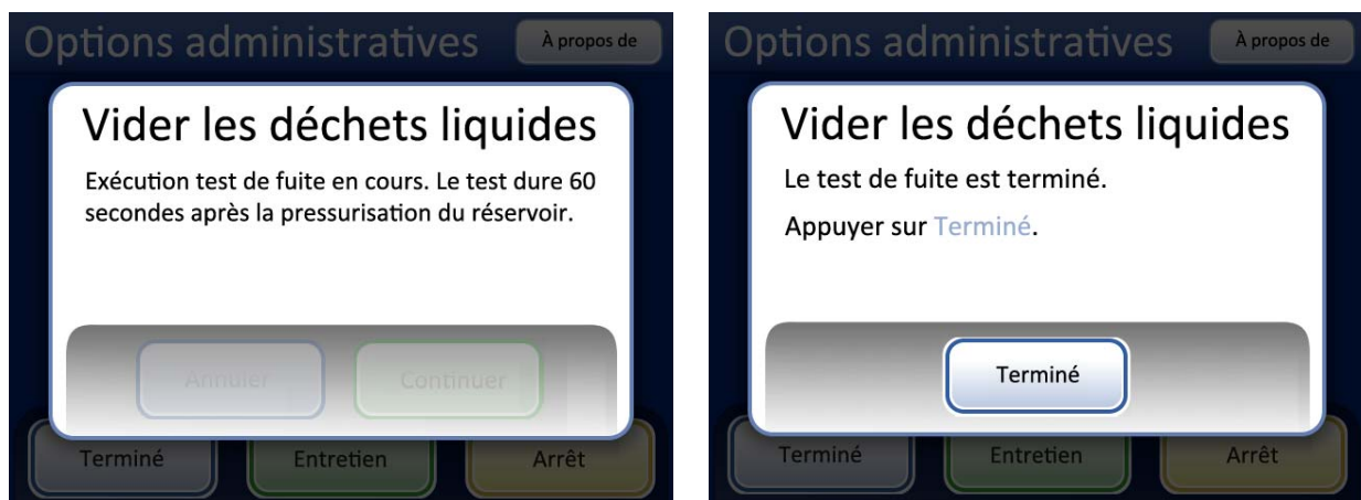
Figure 8-11 Test de fuite du système d'évacuation des déchets
